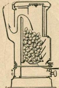
Vue schématique des Calorifères à buse dessus.
