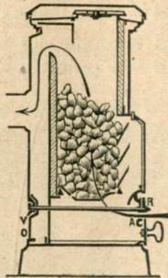
Vue schématique des Calorifères à buse derrière.
