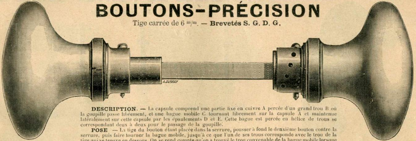
**DESCRIPTION.** — La capsule comprend une partie fixe en cuivre A percée d'un grand trou B où la goupille passe librement, et une bague mobile C tournant librement sur la capsule A et maintenue latéralement sur cette capsule par les épaulements D et E. Cette bague est percée en hélice de trous se correspondant deux à deux pour le passage de la goupille.
