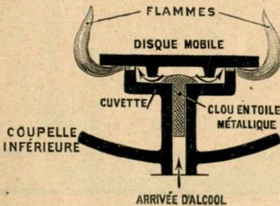
**DESCRIPTION.** — Le brûleur P.-S. est un disque mobile en fonte, portant en dessous des nervures. Il est simplement posé sur la cuvette dans laquelle arrive l'alcool qui s'y vaporise et sort par des encoches ménagées sur le pourtour de la cuvette (Voir la coupe).
